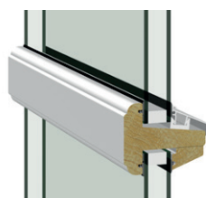
GJENNOMGÅENDE HORIZONTAL SPROSSE - INNSIDE
