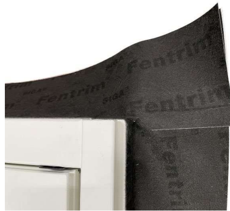
Fig. 3 Eksempel på et vindu for levering med montert teipstrimmel. Ved innsetting av vinduet skal teipstrimmelen klebes mot vindspærren. Figur: Uldal AS
